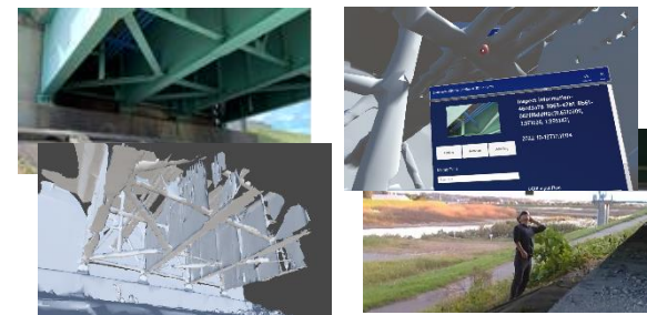
Hololensを用いたSLAMによる3D計測と 点検結果の登録
