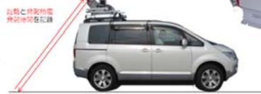
■高精度 IMU と高精度レーザーを組合せ、沿道の 3D 点群データを走行しながら取得
