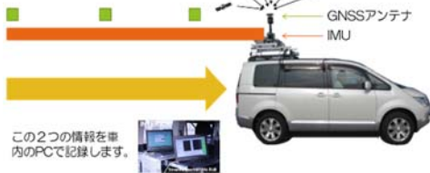
■高精度 IMU と高精度レーザーを組合せ、沿道の 3D 点群データを走行しながら取得
