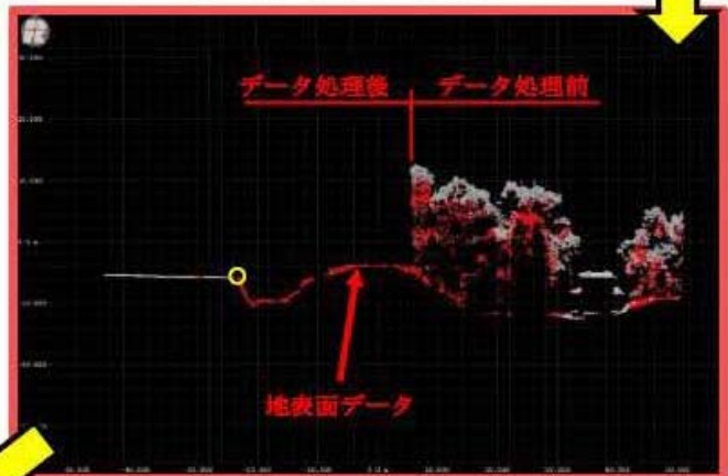
断面計測 (樹木フィルタリング処理後)
